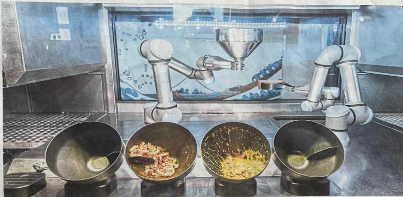
Ein Kochroboter in Aktion: In seinen fünf Induktionsschalen kann er gleichzeitig fünf verschiedene Gerichte zubereiten.
